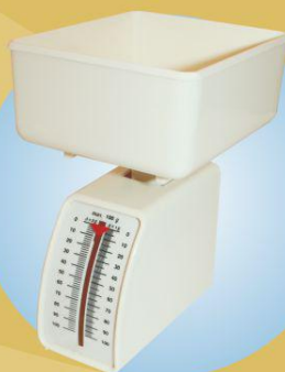
Gramera mecánica BBG Mod. KCF Gramera mecánica carcasa plástica, plato de 12 x 10 cm. y profundidad 5 cm., maquinaria plástica, capacidades disponibles: 100 g. x 1 y 2 g. 500 g. x 5 y 10 g.
